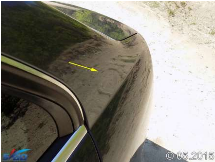
Bild 5: Übersichtsaufnahme Schaden Seitenwand
