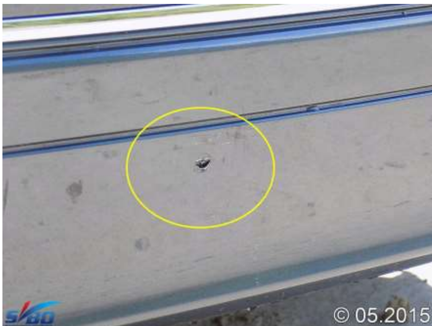
Bild 6: Übersichtsaufnahme Schaden Stoßstange hinten
